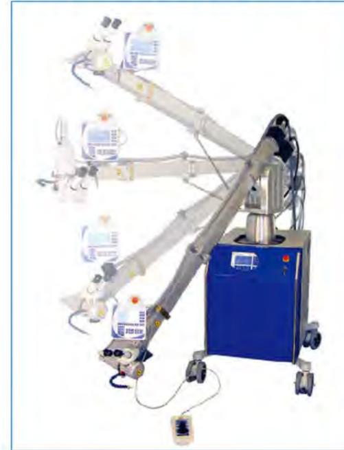
高精度の多軸制御アームが、高さ3m半径3mのエリアを加工可能にしました。これにより、対象物を動かす事なく、精度の高い補修が行えるなど、これまで不可能な加工が可能になりました。もちろん、YAGレーザー溶接の特徴は、他の機械を継承しています。操作方法は手元のデジタルジョイスティックで、4軸制御を極めて高い精度で加工可能としています。また条件設定はあらかじめ50件まで登録可能で、操作しやすいタッチパネルで行えます。その他、自動繰り返し可能なティーチング機能など、作業効率の大幅向上を約束します。
